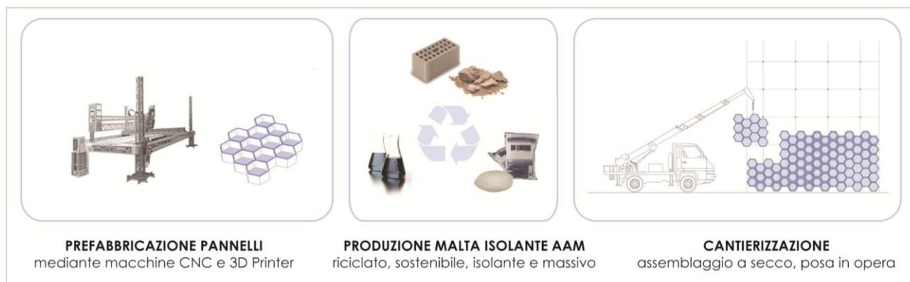
Figura 3. Simulazione del processo di prefabbricazione, assemblaggio a secco e posa in opera dei pannelli.
