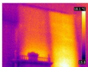
TERMOGRAFIA 1: struttura a telaio portante ligneo della parete, primo piano.
