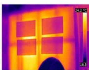
TERMOGRAFIA 2: struttura del telaio ligneo, secondo piano.
